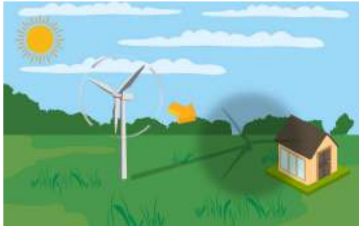
Figura 1. Representación del efecto de sombras intermitentes provocadas por un aerogenerador en funcionamiento
