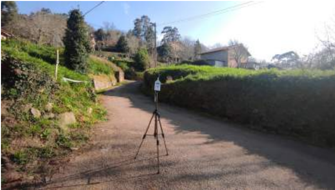
Foto 1. Medición de ruido de fondo en AST2-01 (Trasvilla).
