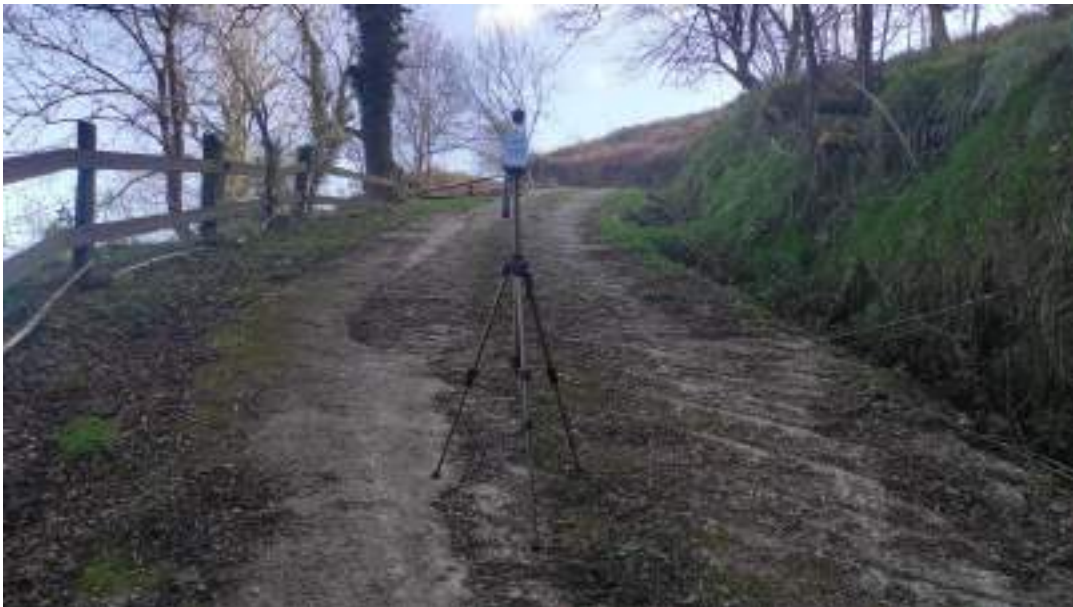
Foto 2. Medición de ruido de fondo en AST2-02 (el Currillo).
