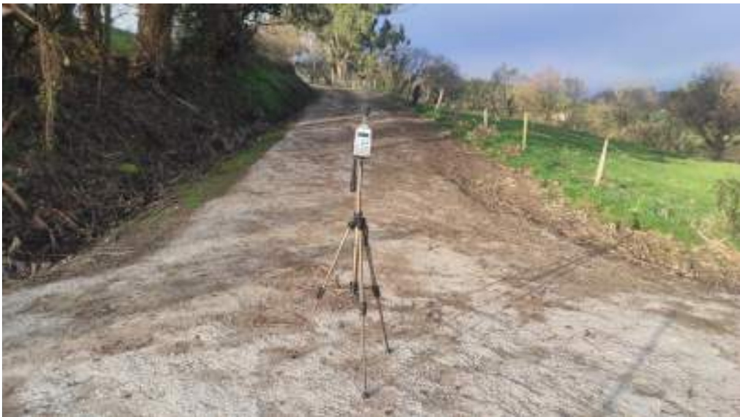
Foto 4. Medición de ruido de fondo en AST2-04 (pista).
