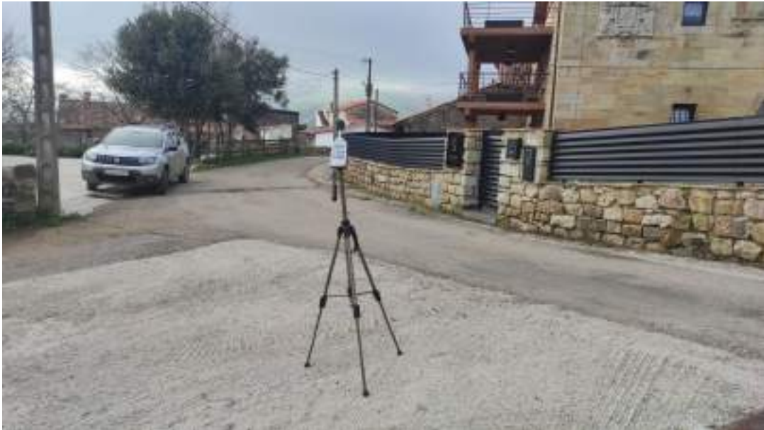
Foto 3. Medición de ruido de fondo en AST2-03 (Sandoñana).
