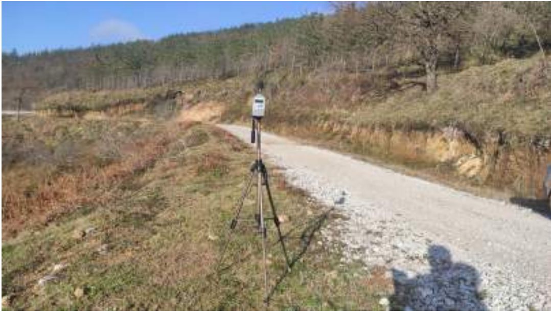
Foto 5. Medición de ruido de fondo en AST2-05.
