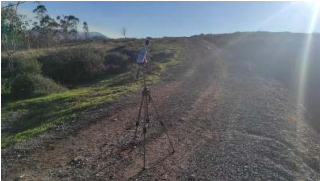
Fotografía 4. Medición de ruido de fondo en AST1-4 (aerogenerador 6).
